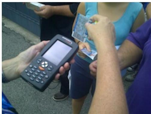
Per il sistema di controllo delle schede non sono necessari infrastrutture Wi-Fi; la comunicazione con la piattaforma centrale, sviluppata a Gallarate, avviene tramite GPRS, abbattendo così costi di adozione della soluzione. I lettori di schede sono anche in grado di leggere biglietti cartacei tradizionali, interpretando il codice a barre.
